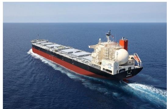
2023年11月14日、伊万里事業所(佐賀県)にて「LNG燃料」大型石炭専用船として受注・建造しておりました載貨重量9万5千トン型ばら積み運搬船「REIMEI(苓明)」を引渡いたしました。本船は当社が建造する初のLNG/MGO二元燃料ばら積み運搬船となります。
