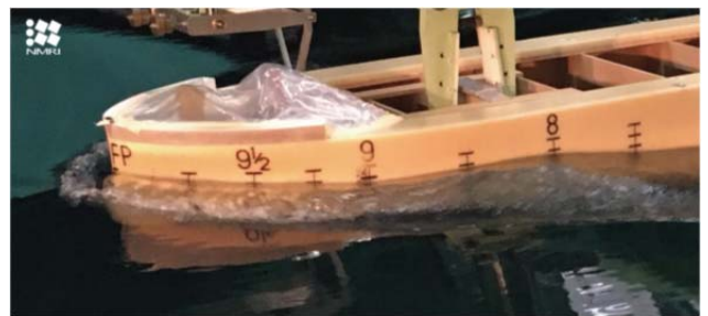
【EEDIweather 認証のための波浪中水槽試験の様子 (VLCC 模型船)】
