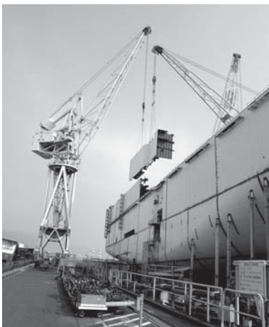
ブロック建造法では、巨大な船も効率よく造ることができます。写真提供:三菱重工業株式会社
