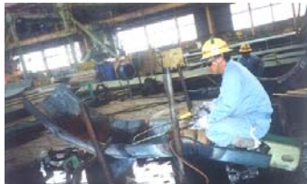
図1 線状加熱による曲げ加工
