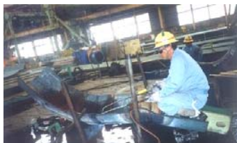
図1 線状加熱による曲げ加工
